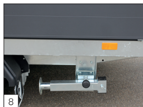
Serienausstattung: die Kürbelstützen sind verstellbar und 90° drehbar.
