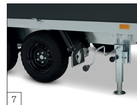
Serienausstattung: 2 schwere Kürbelstützen montiert inkl. Kurbel mit Halter (lose).
