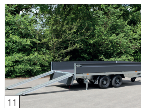
Serienausstattung: 'Auffahr'- Paket montiert (Auffahrschienen und Stützen).
