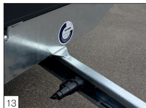
Serienausstattung: Widerstands-unit montiert für die LED-Beleuchtung.
