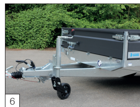
Serienausstattung: verstärktes, klappbares Stützrad montiert.
