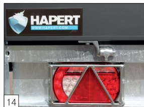
Serienausstattung: Abschirmung der Heckleuchte montiert.
